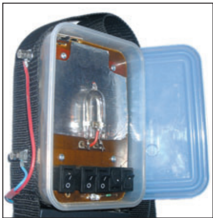
Obr. 5. Svojpomocne vyrobený blesk
