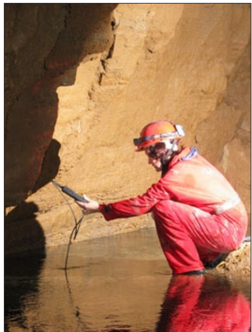
Meranie konduktometrom v Achátovom dóme
