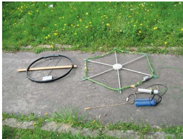
Rádiosonda: zľava povrchová smerová anténa s prijímačom, rozkladacia anténa do jaskyne, zdroj a vysielač
