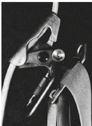
Zlaňovacia brzda autoblokant, bogibbs prsný a bogibbs spodný – šplhacie pomôcky* z roku 1978. Foto: G. Stibrányi
